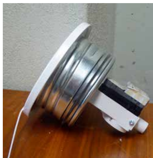
Det mekaniskt tidsstyrda frånluftsdonet i fyrornas duschrum som installerades 2010-11
